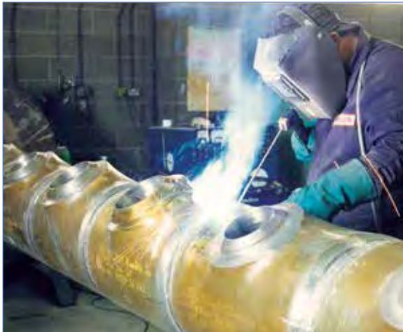
Premier collecteur bimétallique du monde pour tête de puits en X65 revêtu d'un alliage 825
